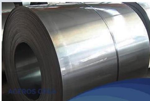
Lámina recubierta por el proceso de inmersión en caliente, a la cual se le aplica un recubrimiento de zinc, apta para aplicaciones en el segmento Construcción. Disponible en **Negra**, Zintro, Zintroalum y Pintro. El acero que se utiliza para la construcción de estructuras metálicas y obras públicas, se obtiene a través de la laminación de acero en una serie de perfiles normalizados.
